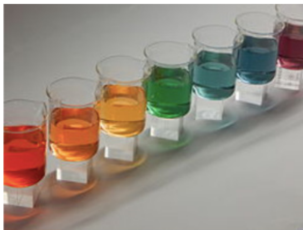
Figura 3.- Cambios de coloración esperados del ácido fosfórico conteniendo el reactivo de Yamada, en función del pH.
